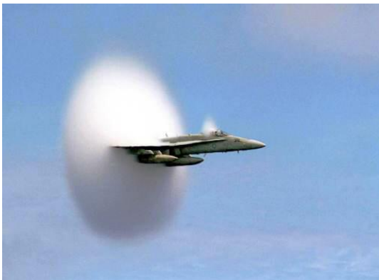
Abb. 5: Machwelle an einem die Schallmauer durchdringenden Flugzeug (links). Shadowgraph Aufnahme des Machkegels eines mit Überschallgeschwindigkeit fliegenden Projektils (rechts).
